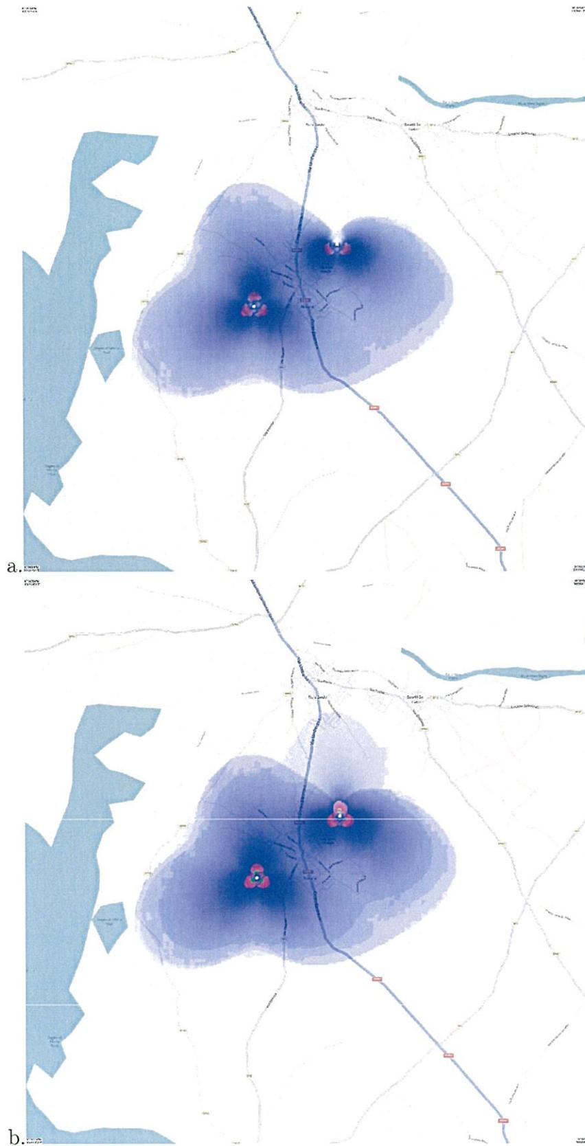
Figura 3.2: Rappresentazione del campo elettrico a diverse altezze dal suolo: (a) 15 metri sul livello del suolo; (b) 20 metri sul livello del suolo
