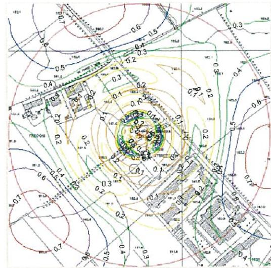
Figura 1.7: Esempio di rappresentazione del campo elettrico attraverso contour plot sovrapposto alle informazioni cartografiche bidimensionali
