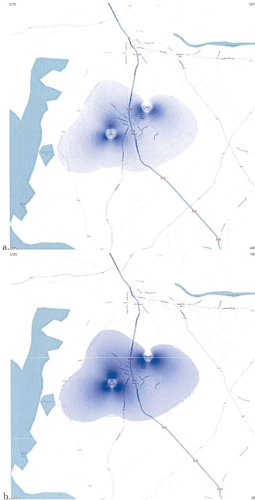
Figura 3.1: Rappresentazione del campo elettrico a diverse altezze dal suolo: (a) 1 m sul livello del suolo; (b) 5 metri sul livello del suolo
