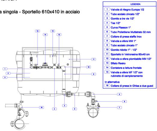
Lo sportello in vetroresina è indispensabile per consentire, anche in seguito, la installazione di contatori con applicazioni per "telelettura", le cui onde radio verrebbero disturbate da sportelli metallici.
